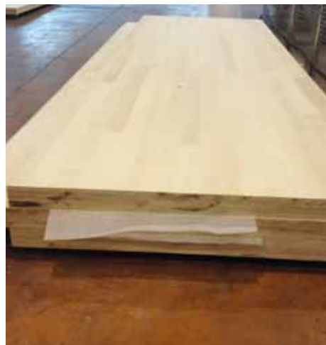
Fünfschichtiges Brettsperrholz für den Einsatz in einem neuen ETH-Forschungsgebäude
