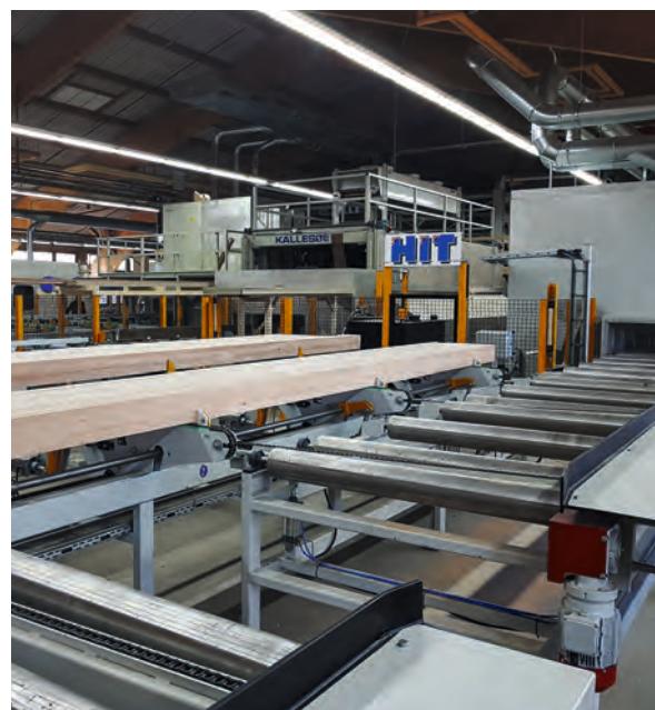
Nach dem Pressen werden die Balken auf das benötigte Endformat gehobelt.
